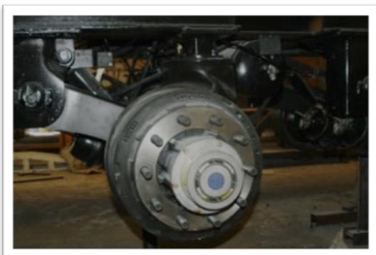
Suspensión de Aire c/Frenos ABS en Remolque
