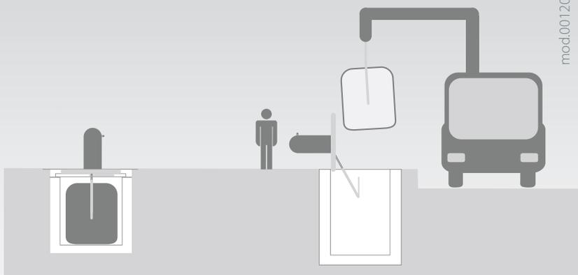
El modelo Citytainer está compuesto por una plataforma metálica única, capaz de alojar hasta 4 contenedores (siendo esta configuración ideal para reciclaje) de 3.000 o 5.000l. La plataforma se sitúa bajo la superficie de la vía pública, la tapa permite un acabado igual al área envolvente del suelo donde se ha instalado. Los contenedores son compatibles con grúas estándar, que estén en conformidad con la norma EN 13071-1. El Citytainer está realizado de acuerdo con la norma EN 13071-2.
