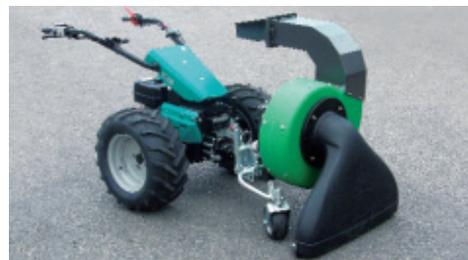
**Aspirador:** Ancho de trabajo: 800 mm, 2 ruedas ajustables en altura, bolsa de 270 litros
